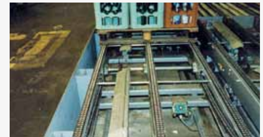
Schmierung von Transportketten für Paletten
