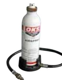
Comment faire : verser du produit dans la bombe Airspray, introduire le tube plongeur avec l'adaptateur, placer la valve avec diffuseur sur l'adaptateur et serrer à la main avec l'écrou-raccord. Placer la bombe avec la valve sur la station de remplissage, appuyer vers le bas pendant environ 2 s. La bombe est prête à pulvériser.
